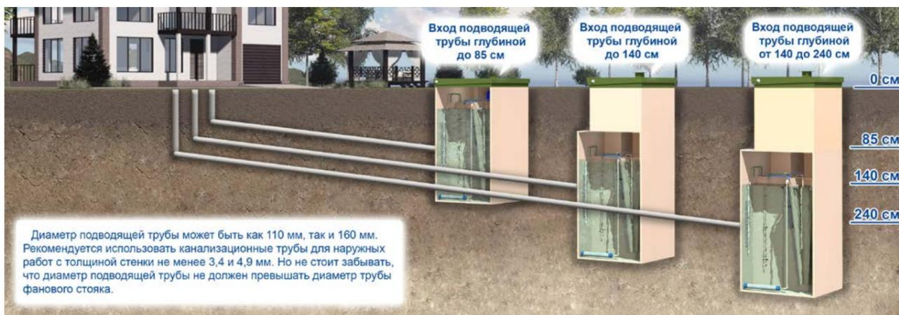
**Подсказка (Пример подбора УОСВ по глубине залегания подводящей трубы):** Стандартная УОСВ в высоту 2 м 30 см (без учета воздухозаборника), верхняя часть, которой находится над поверхностью земли (15 см), при этом 2 м 15 см остаются под землей. Врезка подводящей трубы в стандартное сооружение возможна на глубине от 35 см до 85 см (по нижнему краю трубы) от уровня грунта. Рекомендуемый производителем диапазон (оптимальное значение) от 45 см до 65 см.
