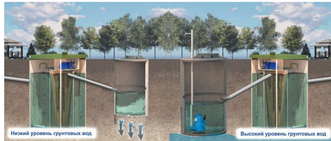
**ВНИМАНИЕ:** не рекомендуется сливать в УОСВ большое количество бытовой хлорсодержащей химии и стоки, образующиеся при промывке фильтров водоподготовки!
