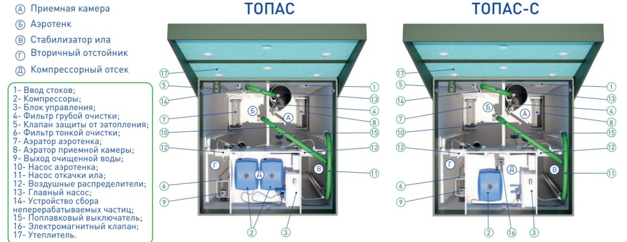
УОСВ осуществляют очистку, а не аккумуляцию (накапливание) стоков. Работа УОСВ основана на принципе SBR-реактора: в одном активном объеме сооружения (приемной камере и аэротенке) сочетаются аэробная и анаэробная очистка при использовании системы прерывистой (импульсной) мепкопузырчатой аэрации. Дополнительно в фазе выключения аэрации происходит процесс отстаивания загрязнений.
